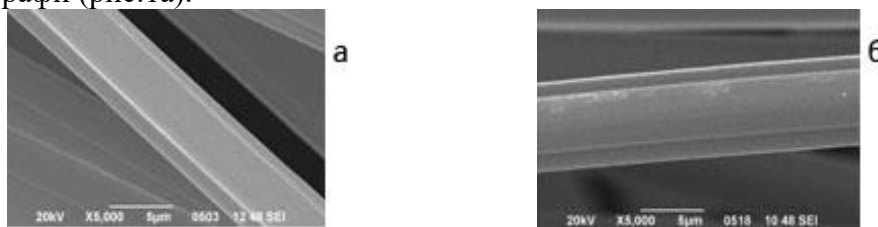
Рис. 1. Мікрофотографії поверхні зразків: а – Бусофіт, б – Бус/CCl 4 . Збільшення – 5000 разів.
